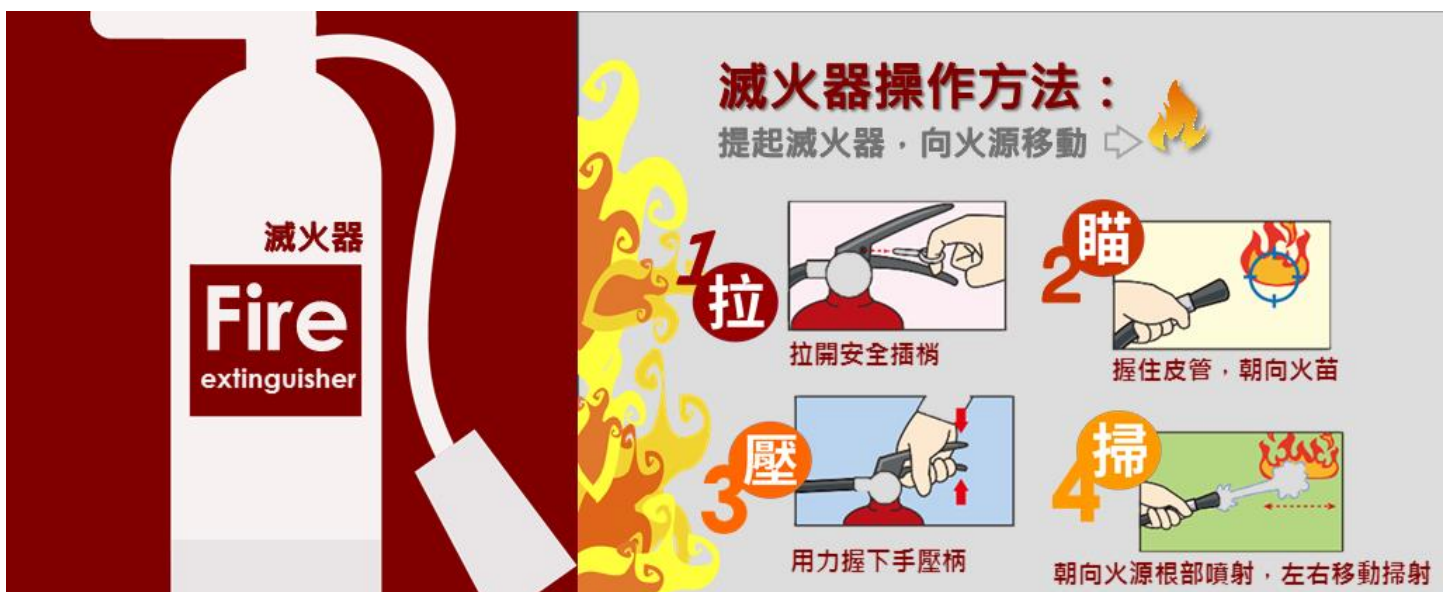
圖 2.2-2、滅火器使用方法
